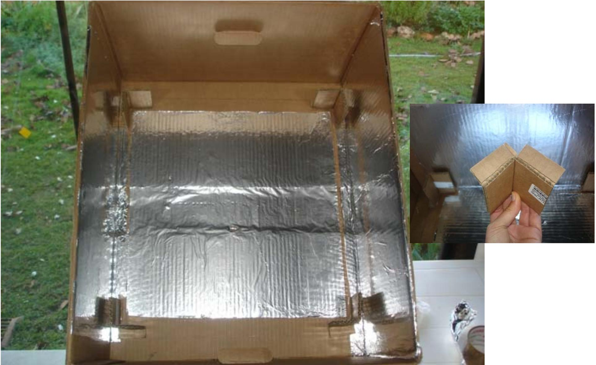
Para que a caixa de dentro fique firme e centralizada, faça, com papelão dobrado e colado no fundo, quadro suportes como mostrado na foto acima.
