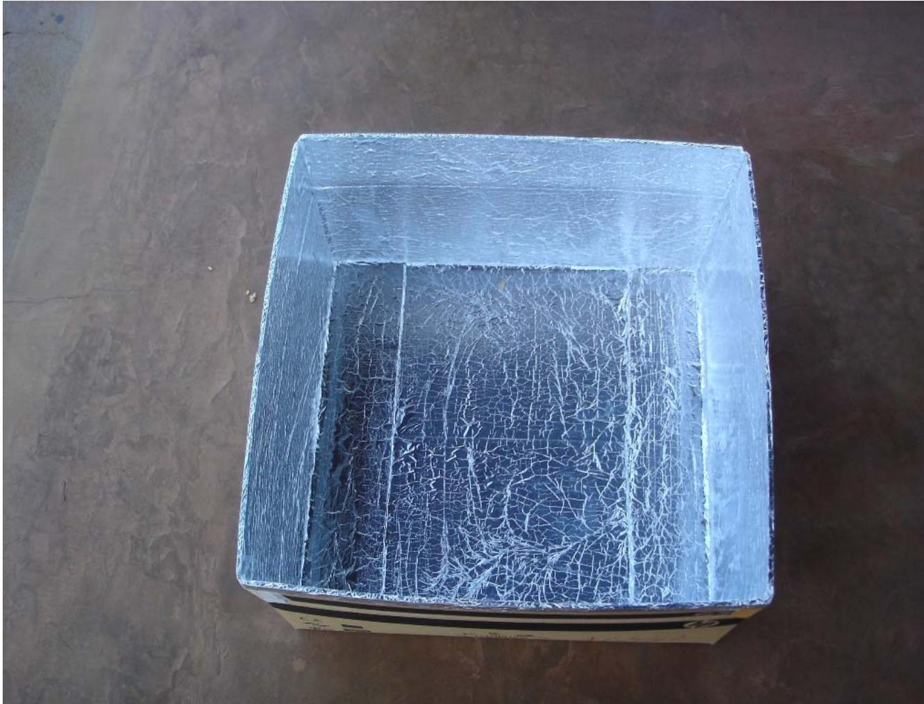
Em seguida, cole papel de alumínio de modo a cobrir todo do fundo e as laterais da caixa interna. Isso aumentará a superfície de reflexão e a eficiência térmica do fogão.
