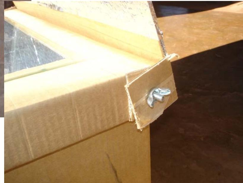
Estamos quase nos finalmentes, mas ainda falta o refletor. Para prepará-lo, corte um pedaço de papelão do tamanho da tampa, deixando duas abas com suporte para prender na tampa. Cole papel de alumínio em uma das faces. Prenda o refletor na tampa fazendo um furo e utilizando um parafuso de rosca com uma porca ou uma borboleta.
