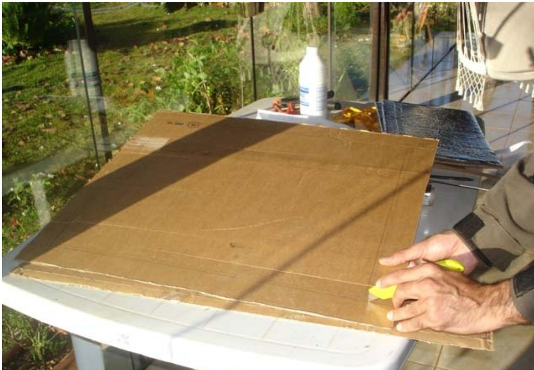
O próximo passo é fazer a tampa do fogão. Marque o contorno do fundo da caixa maior em um pedaço de papelão. Em seguida, deixe uma sobra de 5 cm de cada lado para fazer a dobra da tampa. Corte o papelão.
